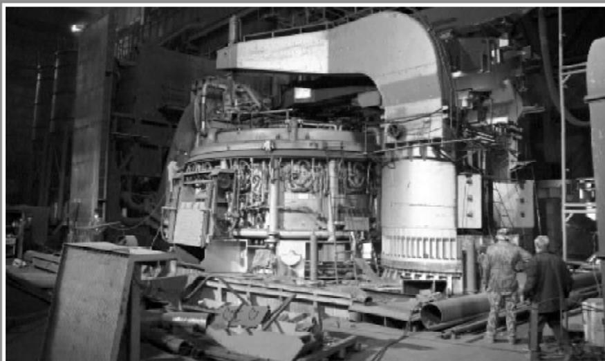
Участок ДСП-125, новая печь фирмы «Concast». Более современная и производительная, она позволит существенно увеличить объемы выплавляемой стали. В настоящее время заканчивается монтаж основных узлов и механизмов печи, и в ближайшее время начнется ее горячее опробование.
