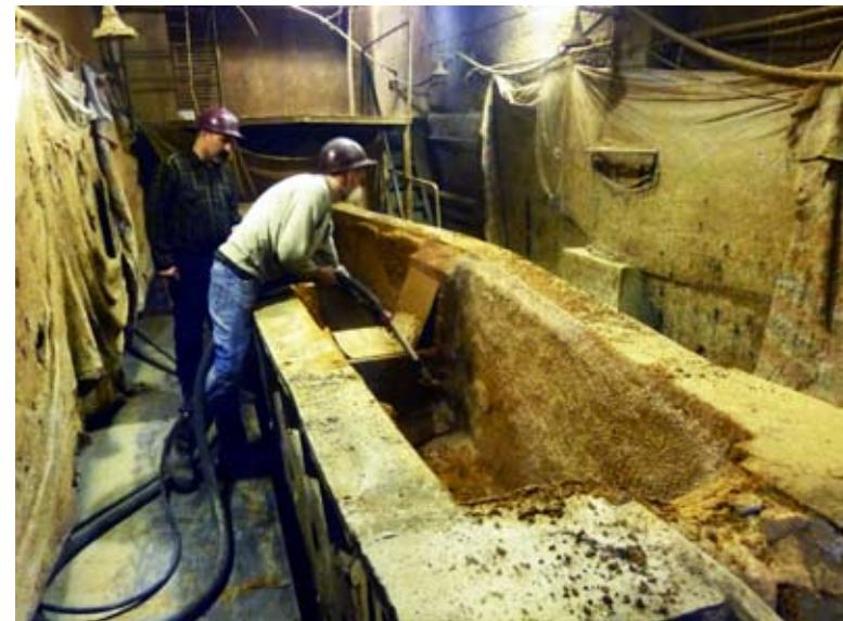
Выполняется торкретирование промежуточного ковша, то есть нанесение рабочего слоя футеровки.
