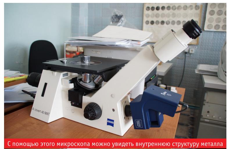
С помощью этого микроскопа можно увидеть внутреннюю структуру металла
